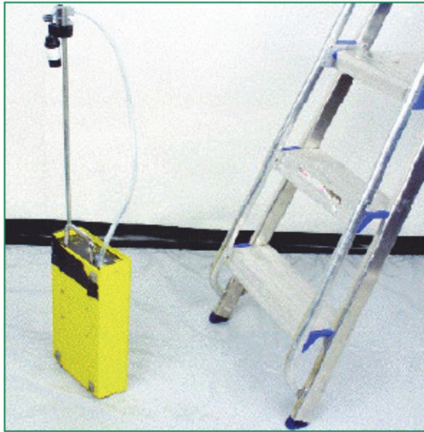
図 6.6 完了検査（クリアランス）中の空気サンプリング
