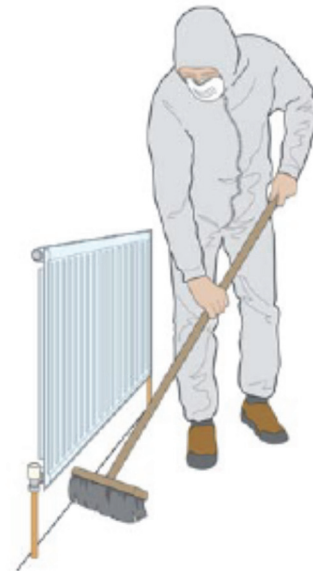
図 6.7 完了検査（クリアランス）中にブラシ掛けを行ってかく乱を起こすアナリスト
