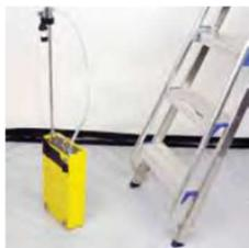
7.132 徹底的な目視検査を実施し、作業計画（POW）に記載されたアスベストがすべて除去され、目で見える破片や付着した粉じんの層がないことをアナリストが納得した場合に、エアサンプリングを行う（図 7.27 参照）。「アスベスト：アナリストのためのサンプリング、分析、完了検査（クリアランス）に関するガイド」<sup>8</sup>で説明されている方法で、信頼性のある数量とされている呼吸性飛散アスベスト濃度の最小値は、有効径 20 mm 以上のフィルターを通過した 480 リットル以上の試料容量に対し、アスベスト繊維 0.01 本/ml である。ほとんどの場合、最終清掃後の吸入可能な飛散繊維濃度が、承認済みの測定方法を用いてこの限界未満になるよう、作業区域を徹底的に清掃することは、合理的に実現可能である。したがって、0.01 本/ml という値が「認可指標」の限界値と解釈される。空気中のアスベスト測定値が、このレベル未満にならない限り、通常、再立入に適した現場とみなすことはできない。
