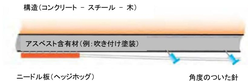
図 7.11 つながれた細い針を用いた制御下での多点注入針
